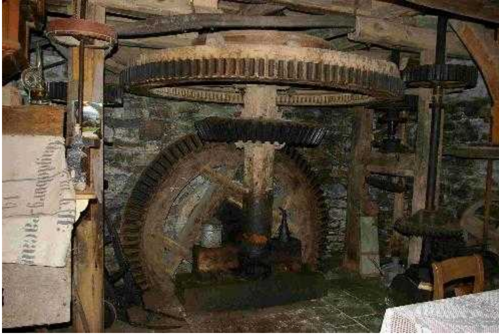
Ein Stockwerk darüber - die Holz umbauten Mühlsteine. Im Vordergrund: Zange zum Anheben der Mühlsteine samt Galgen-Ständerwerk.
